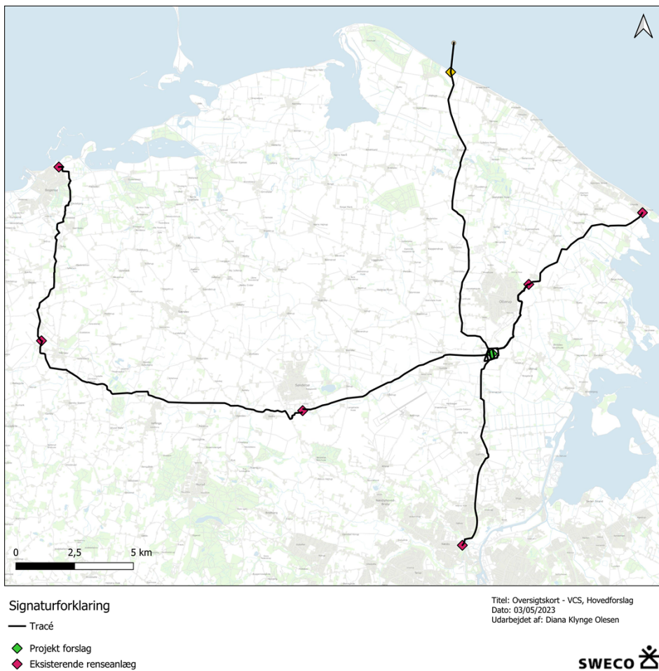
Figur 2-2. Viser hovedforslaget for placeringen af det nye renseanlæg (grøn firkant), placering af transportledning (trace), eksisterende renseanlæg (rød firkant), udløbspunkt (gul firkant, pumpestation/overgangsbygværk) og havledning.
