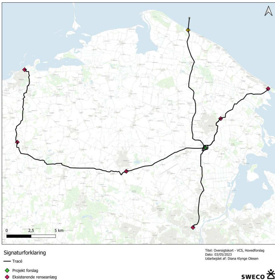
Figur 2-2. Viser hovedforslaget for placeringen af det nye renselanlæg (grøn firkant), placering af transportledning (trace), eksisterende renselanlæg (rød firkant), udløbspunkt (gul firkant, pumpestation/overgangsbygværk) og havledning.
